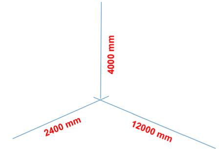
**DIMENSÕES APROXIMADAS PARA ESPAÇO FÍSICO CAPACIDADE 75 m³/h**
